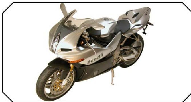
Den Seitenständer mit dem Fuß bis zum Anschlag ausklappen und das Motorrad langsam neigen, bis der Ständerfuß auf dem Untergrund fest aufliegt.
