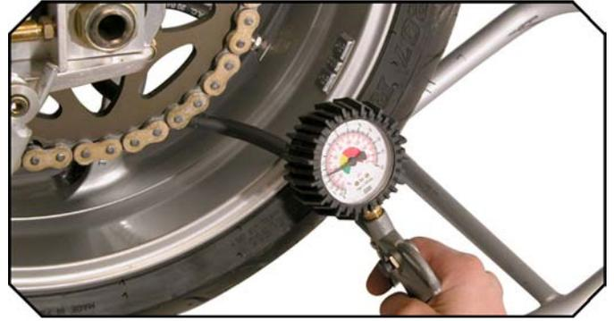
Die Kontrolle des Reifendrucks ist von grundlegender Bedeutung für die Fahrsicherheit.
