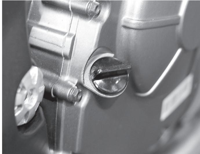
Der Ölmesstab befindet sich auf der rechten Seite des Fahrzeuges.
